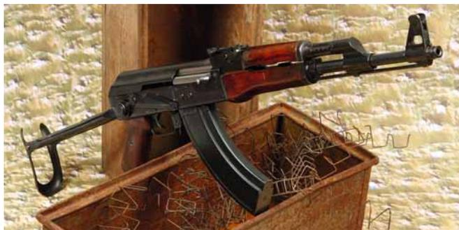
Un Aks (versione a calcio pieghevole dell'Ak 47) nella primissima configurazione, con fusto stampato di primo tipo, poi sostituito dal fusto realizzato dal pieno.
