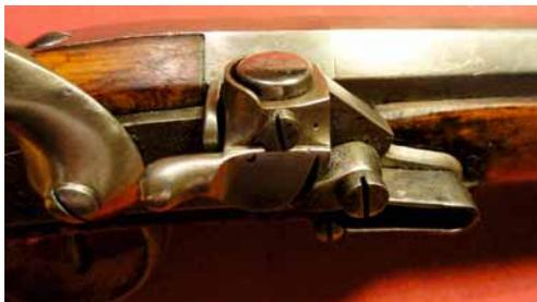
Dettaglio del sistema Augustin, utilizzato in sostituzione del sistema Console di poco precedente.
