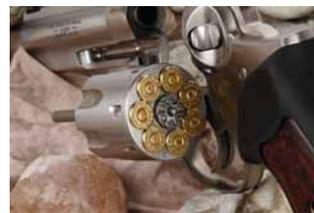
Il Ruger Gp100 a 7 colpi pare soffrire di un eccessivo "affollamento" delle camere del tamburo, che in alcuni casi determina difficoltà di estrazione dei bossoli.
