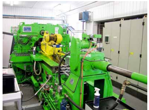
Una macchina per eseguire la rotomartellatura a freddo delle canne.
